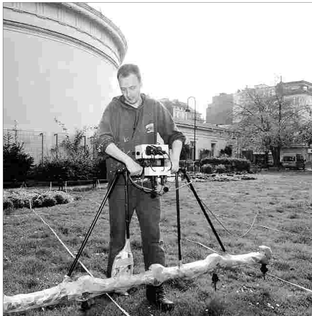
Mess-Experte Heiko Rantze in Aktion: Stromflüsse sollen Neues verraten über etwaige Bauwerke unterm Elisengarten. Foto: Michael Jaspers
